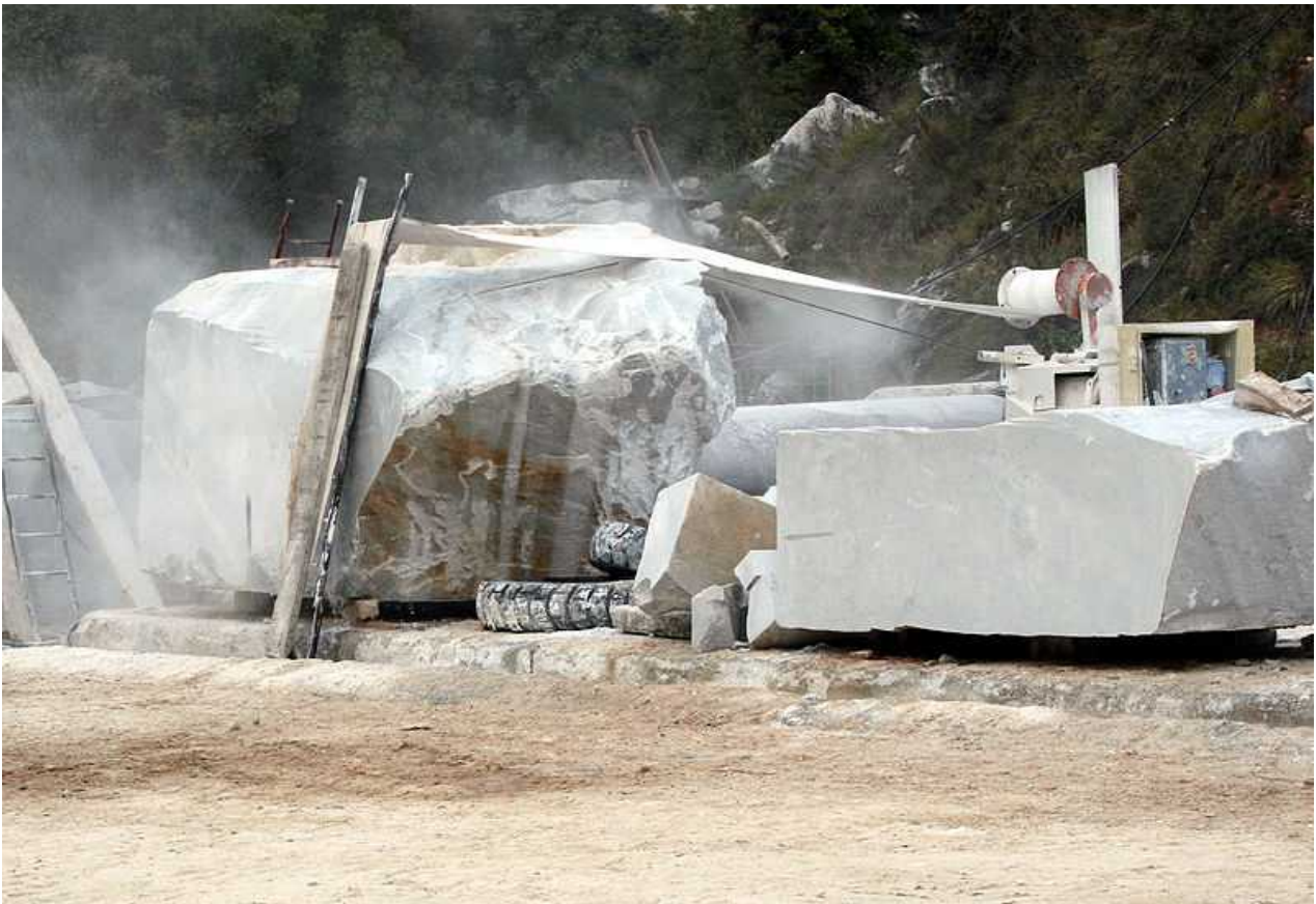
Abb. 5 Moderne Seilsäge in Carrara
