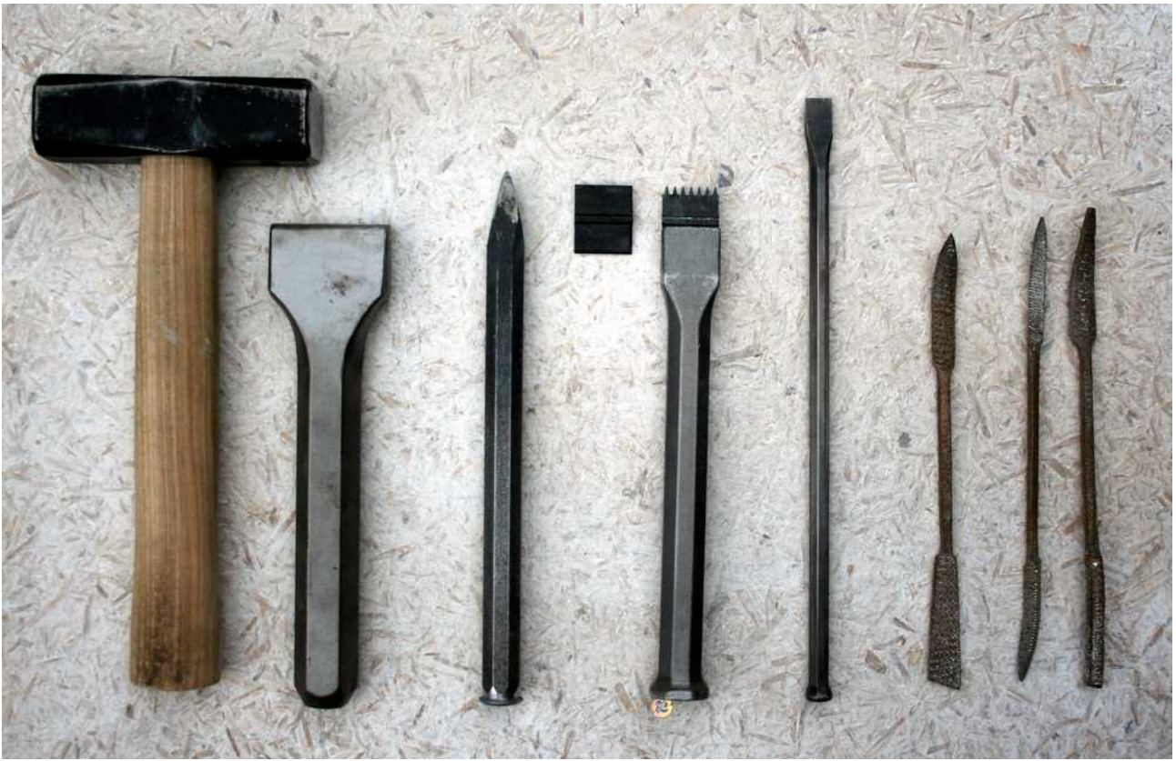
Abb. 14 Werkzeug zum Steinhauen (v. l. n. r.: Fäustel, Spreng Eisen, Spitzeisen, Scharriereiseneinsatz, Halter mit Zahneisen, Schrifteisen, Raspeln)
